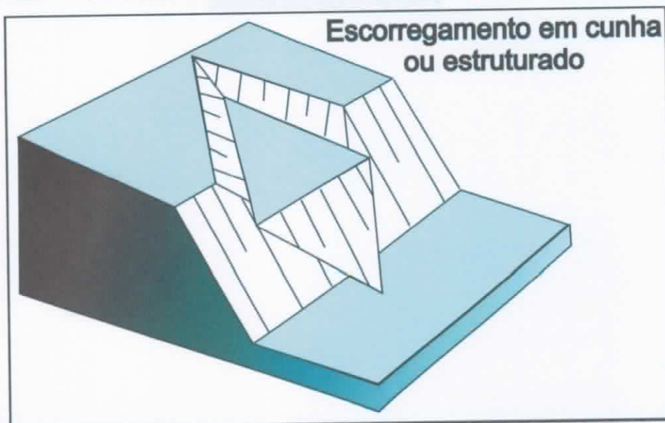
Figura 7 – Perfil esquemático de um deslizamento em cunha ou estruturado (Min. das Cidades, Inst. de Pesquisas Tecnológicas do Estado de SP – IPT, 2007).
